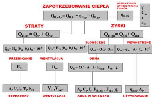
Rys. 1. Schemat obliczeń zapotrzebowania na energię do ogrzewania zgodnie z metodyką obliczeń charakterystyki energetycznej budynku [5]
